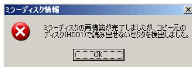
(注) 上記画面は、HDDベイ1に実装されたHDDでリードエラーが発生したことを示しています。
