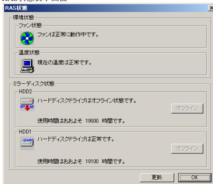
(注) 上記画面は、HDDドライブベイ2に実装されたHDDが異常であることを示しています。
