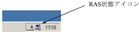
両系のHDDが正常な場合は、以下のようなHF-W RAS状態画面が表示されます。
