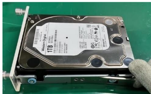
②側面の金具を開きながら、ゴム付きネジをHDDトレイにはめ込む。
