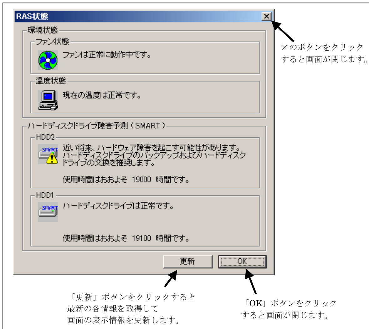
図 8-6 RAS 状態表示ウインドウ（ファン状態：正常、温度状態：正常）
