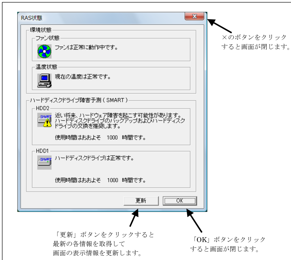
図 8-6 RAS 状態表示ウィンドウ (ファン状態 : 正常、温度状態 : 正常)
